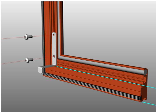
Für Kunststoff- und Alufenster wird der untere Winkel in der Regel am unteren Anschlag montiert, was einem Abstand von  $A=15$  mm entspricht.
