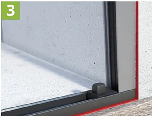
**3** Das seitliche Montageprofil auf der Seite des Gewebepakets in der Rollladenführung oder dem Mauerwerk verschrauben.
