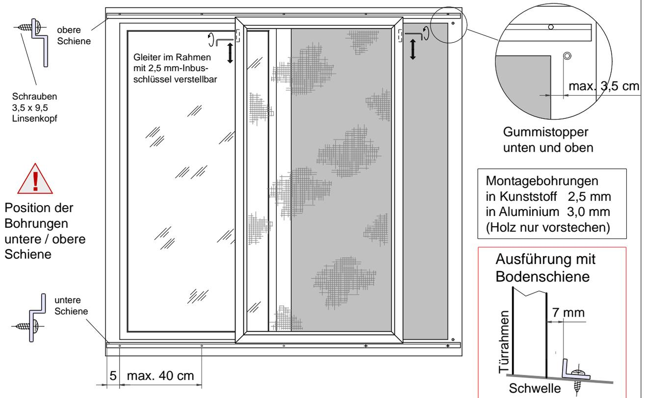
1. Befestigungslöcher 4 mm in die Laufschiene bohren, falls diese nicht vorgebohrt bestellt wurden. (Achtung: untere und obere Schiene werden unterschiedlich gebohrt!)
